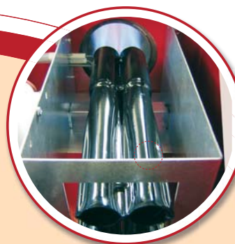
Горелки мультивентури с тягой воздуха
